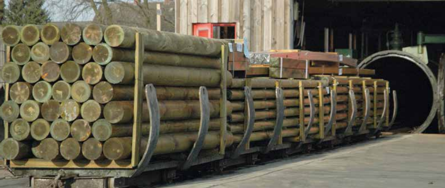
Loren mit Gartenholz – Beladen der Kesseldruckanlage
